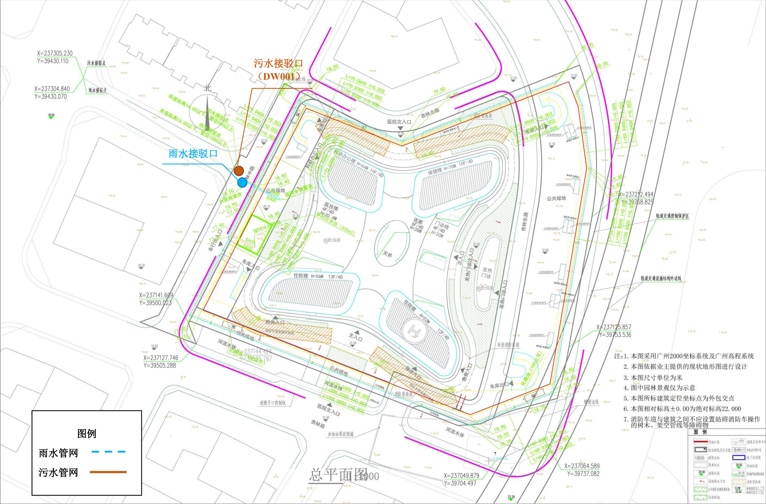
图 2.2-4 院区雨污管网铺设情况图
